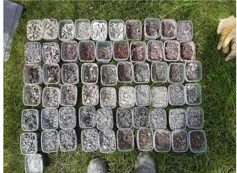
Bohrung im lärm- und erschütterungsarmen Verfahren (Meißelbohrverfahren mit Luftspülung und Gewinnung von Bohrklein)
